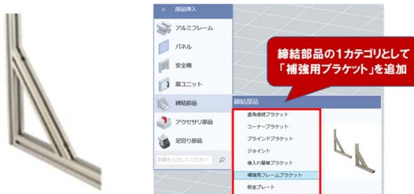
補強用フレームブラケットを用いてアルミフレームを斜め配置(左)、締結部品の選択画面(右)
